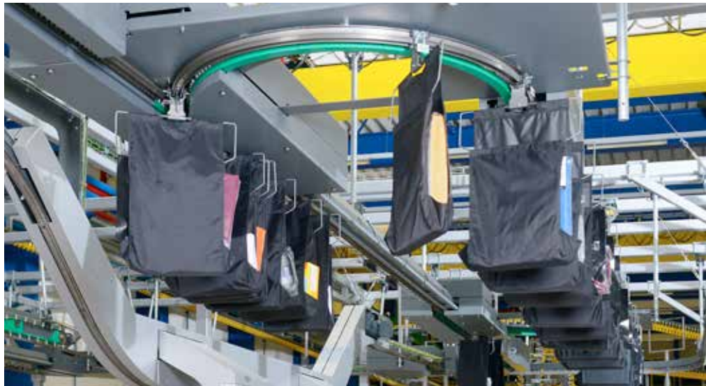
Schon bei geringem Gefälle arbeitet die innovative Technologie ausschließlich mit Schwerkraft.
