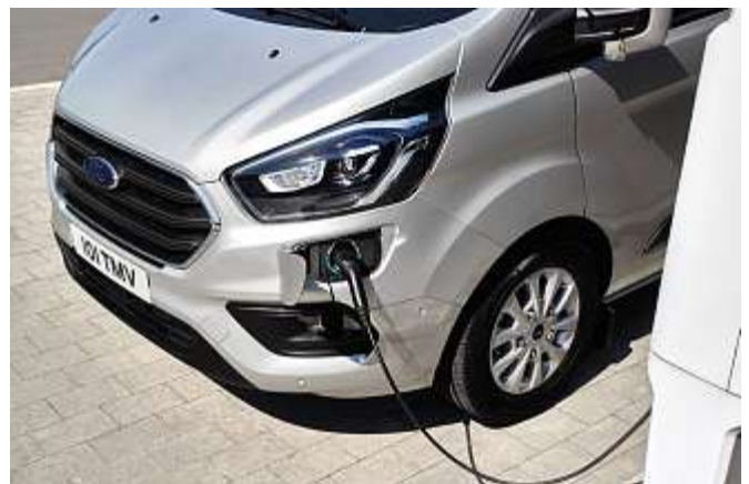
Der Ford Transit Custom PHEV. Eine Erkenntnis aus dem Pilotprojekt war, dass der Anschluss für das Ladekabel nach vorne links versetzt wurde.
